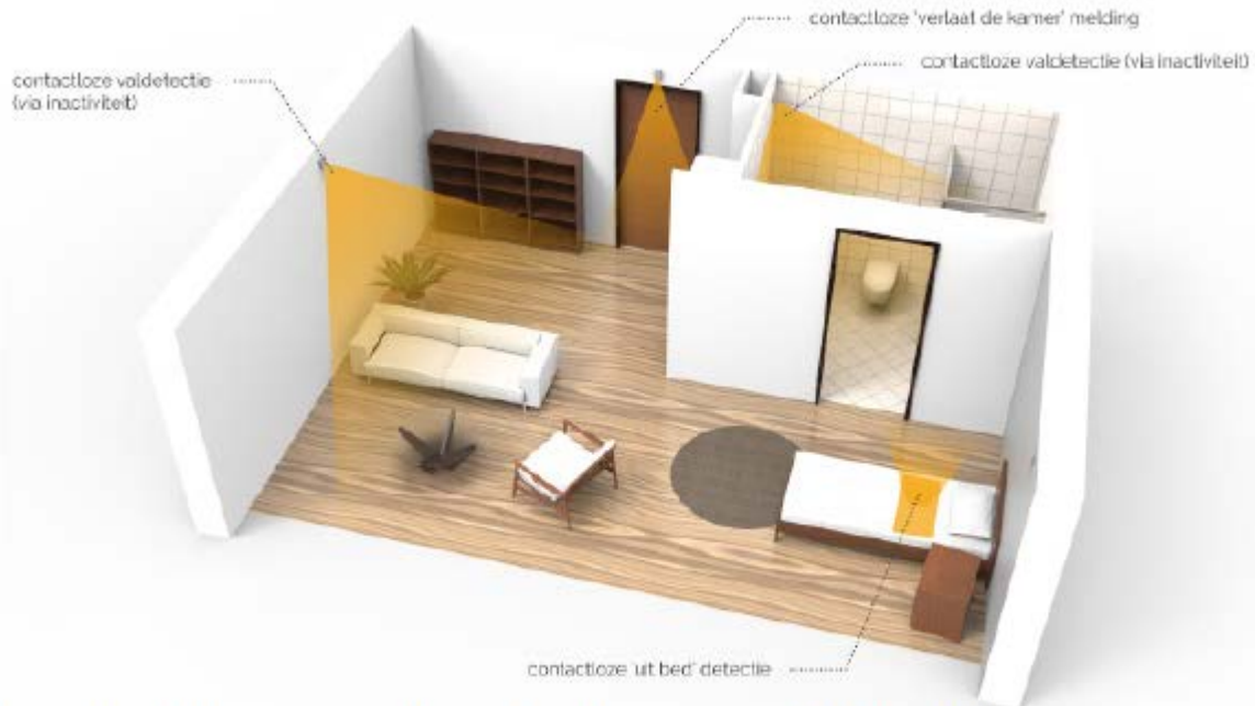
Figuur 2: Voorbeeld van sensorische bewaking derde generatie, het Unattended Autonomous Surveillance (UAS) systeem van Ascom/Dutch Domotics (2015) 8
